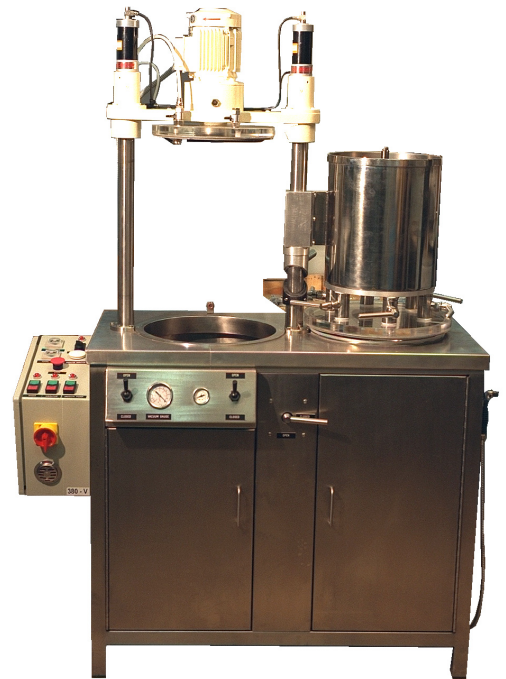
Posición de carga, agua y revestimiento. Loading position, water and investment.
